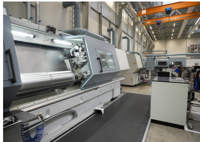
Auf modernen CNC-Drehmaschinen werden die Seiltrommeln in einer Aufspannung gefertigt. Dieses Verfahren garantiert einen einwandfreien Rundlauf der Seiltrommeln.
