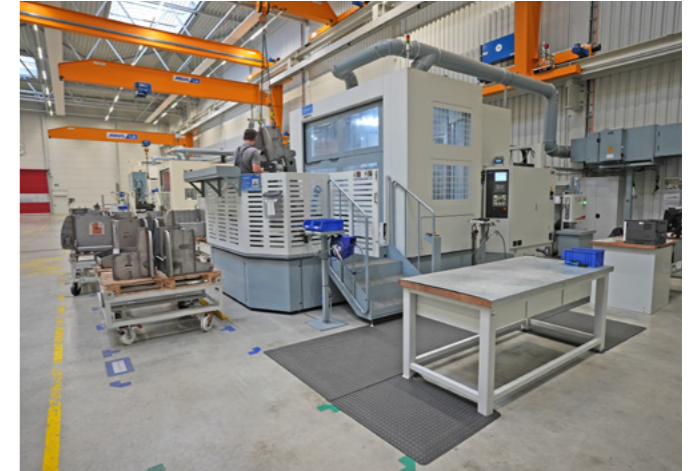
Mechanische Bearbeitung des Seilzug-Gehäuse auf 4-Achsen Fräszentren
